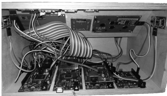
Рис. 3. Компоновка прибора, созданного школьником в результате дополнительной самостоятельной работы
